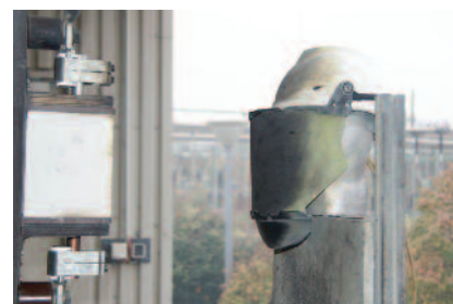
Test podle normy GS-ET-29 třída 2-7 kA byl úspěšně absolvován. Kombinace ochrany hlavy a obličeje chrání nositele
